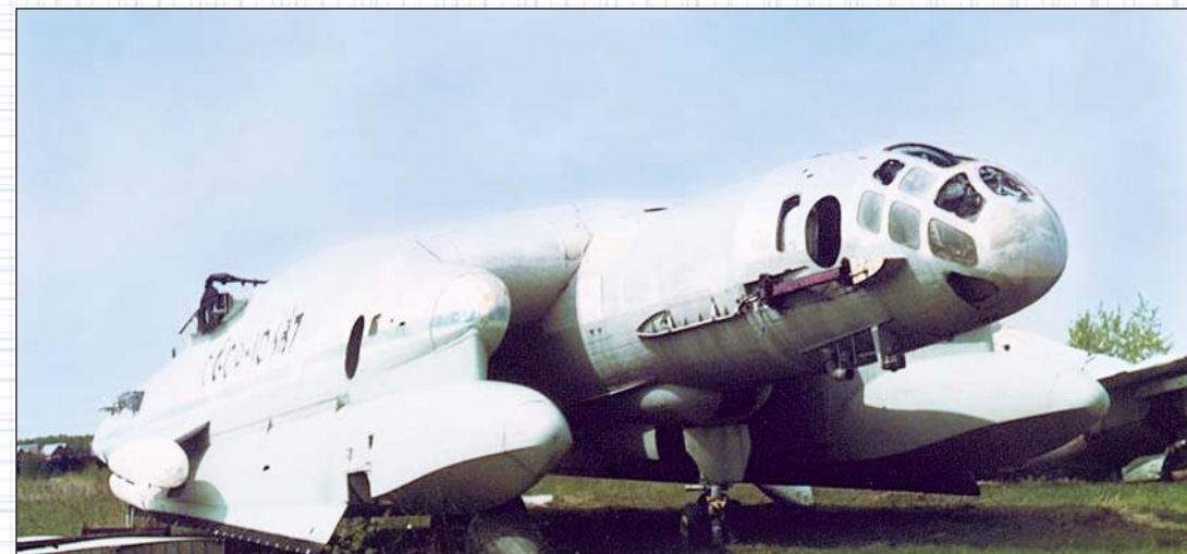
Экспериментальный вертикально взлетающий самолет-амфибия ВВА-14.
