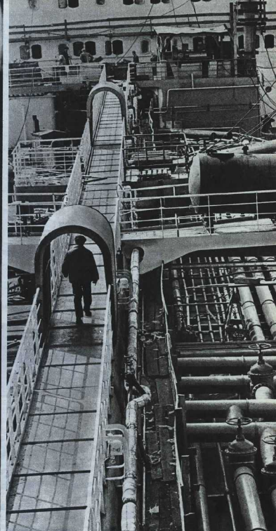
Забормый трубопровод, а там внизу, в трубе, — танки, в которых будет перевозиться драгоценный груз — нефть.
