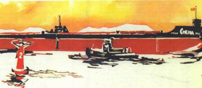
нича здесь нет. Только два самостоятельных корпуса. Кто будет днагать судно? Вот тут к корне присоединяется баксир-толчки. Получается, что судно — это не судно, а баксир-толчки паровоз, вагонетка, разгрузка — и побежал рабочий на плавник. Пришло судно в порт, баксир-толчки расставляет быстрым полусекундами по соответствующим причалам, и покажалась — разгружайся. А сам в это время другую работу делает. Даваж детям понятно.
