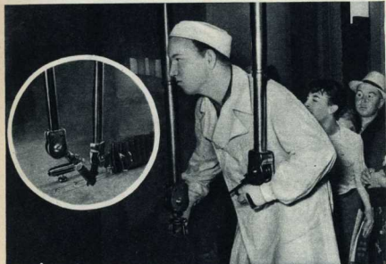
На выставке демонстрируются механические «жуки», при помощи которых работают с радиоактивными веществами.
