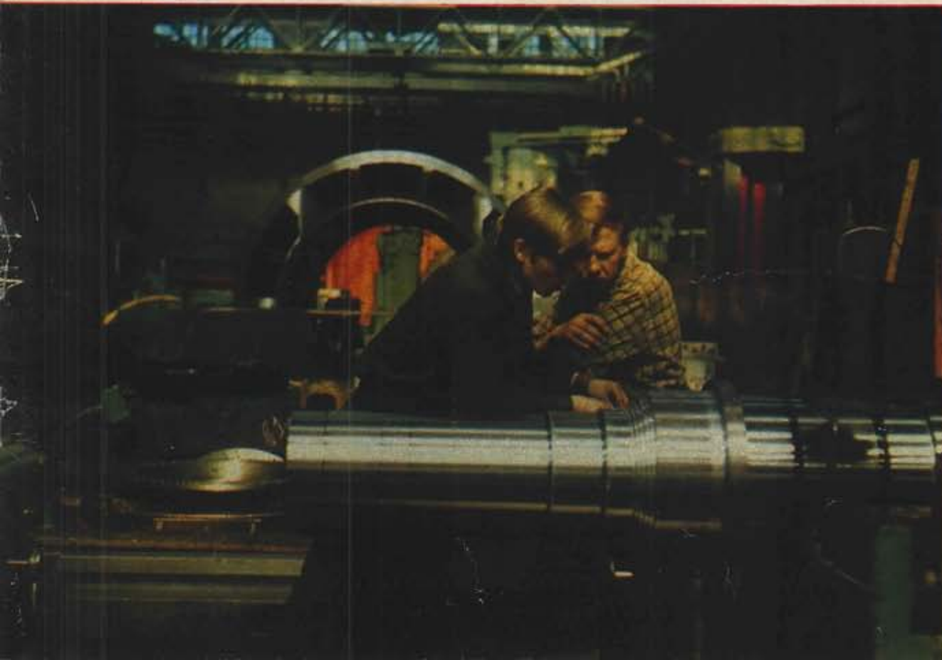
ВАЛ РОТОРА ПОДВЕРГАЕТСЯ ТОНЧАЙШЕЙ ТОКАРНОЙ ОБРАБОТКЕ.
