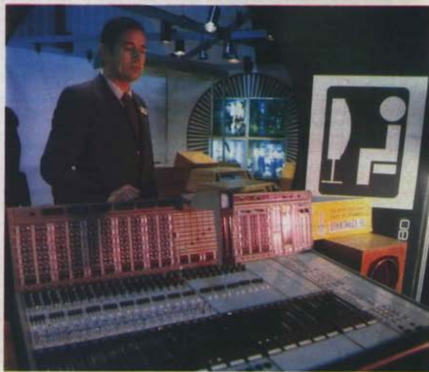
Специально для «Олимпиады-80» ленинградские радиоинженеры создали режиссерский пульт для комментаторов. Он позволяет вести репортаж с любой точки спортивной арены.
