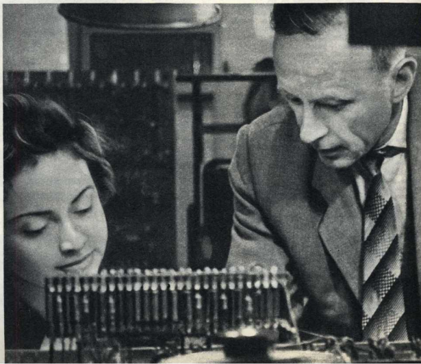
Инженер ЦЛА Евгений Сергеевич Геништа и техник лаборатории комсомола Эмма Костенко проверяют монтаж одного из узлов вычислительного устройства.
