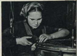
Такии дополнительным способом производится сейчас затяжка спиц.
