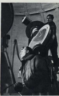
СОЛНЕЧНЫЙ ТЕЛЕСКОП ВЫГЛЯДИТ НЕКОЛЬКО НЕПРИВЫЧНО. ЛАБОРАНТЫ АРХИВА ВЛАДИМИРА ШЕЙНА ЛОВЯТ ЗЕРКАЛО СОЛНЕЧНЫХ ЛУЧ И НАПРАВЛЯЮТ ЕГО НА САМОЕ ДНО ВЫСОКОЙ БАШНИ ДЛЯ СПЕКТРОГРАФИЧЕСКИХ ИССЛЕДОВАНИЙ.
