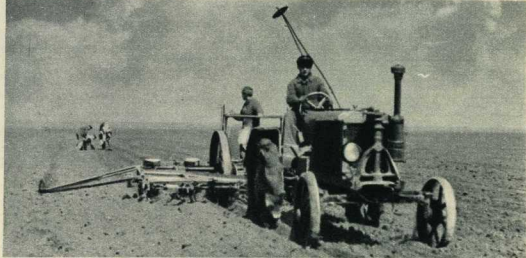
Квадратно-гнездовая посадка кукурузы агрегатом «КГ-6».
