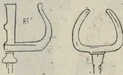
Обыкновенная уключина (справа) и уключина широкого типа (слева).
