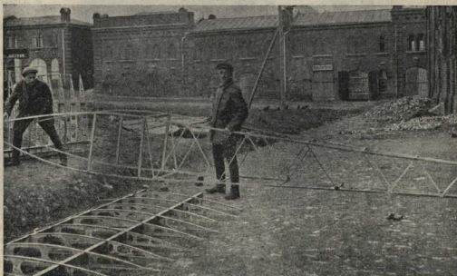
ВВЕРХУ (рис. 11): Крыло и недокопченный фюзеляж планера, belonging Подольским планерным кружком. В СЕРЕДИНЕ (рис. 12): типовые алюминиевые багмаки для уловок крепления; и в угловых багмаки стоек фюзеляжа, с-обима крыла и стоек шасси. ВНИЗУ (рис. 13): устройство крыльев Подольского планера.
