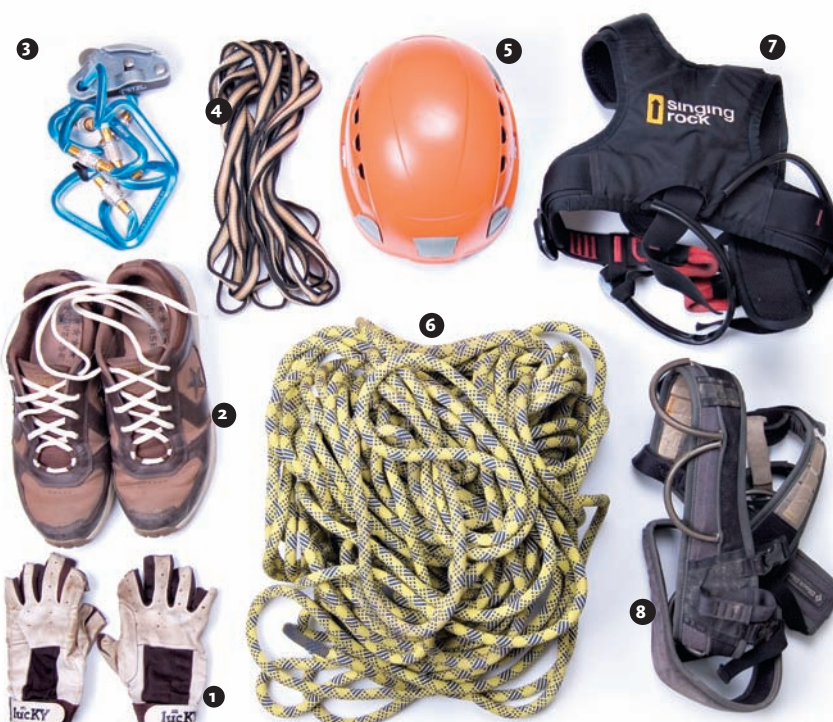
1 – перчатки; 2 – удобная обувь; 3 – карабины «пятитонники» и спусковое устройство gre-gre; 4 – страховочные петли; 5 – прочный шлем; 6 – веревка альпинистская: новая, надежная; 7, 8 – системы страховочные: грудная и поясная части.
