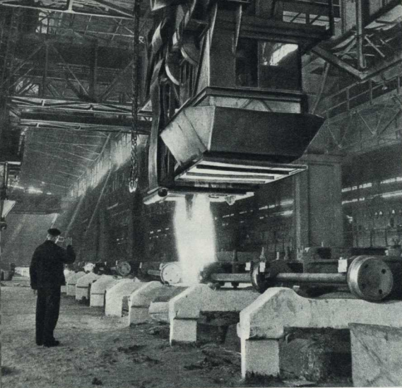
Из нагревательных колодцев слитки идут в прокат. Первосортную сталь получит Родина!
