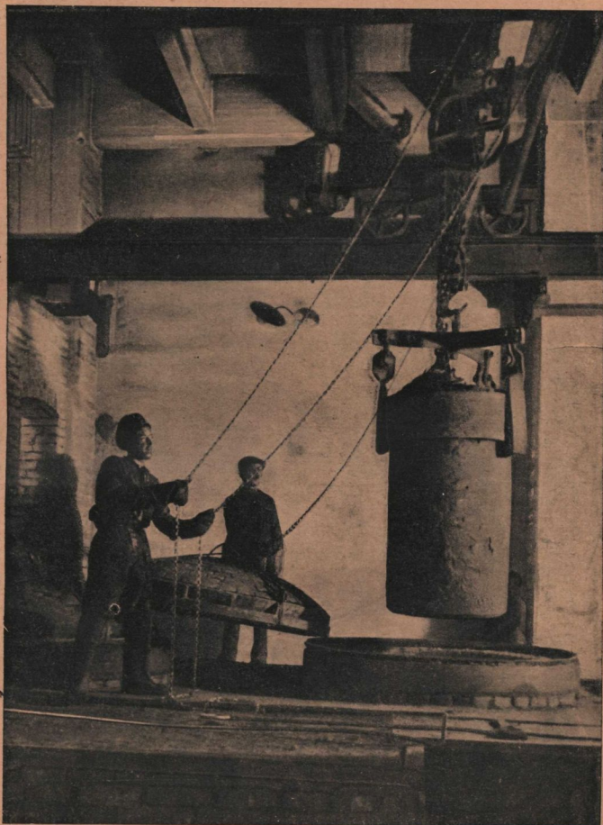
ЗАВОД „МЕТАЛЛ“ ГЭТ'а. Закладка железной болванки в обжигальную печь.
