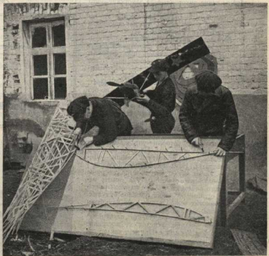
Сборка червор крыла планеристами Ново-Богородского кружка. Вверху — червор нормального планера, внизу — баллансирный. (Рис. 8).
