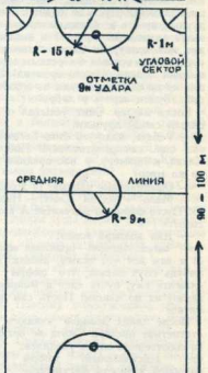
Схема поля для русского хоккея. Размеры ворот: высота — 120 см, ширина — 40 см.
