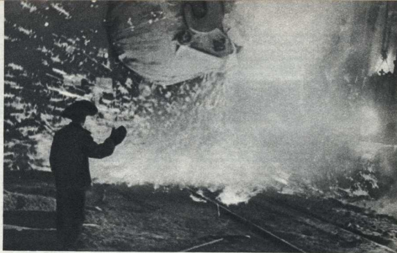
Влетает спол искр: в печь заливается «порция» жидкого чугуна.
