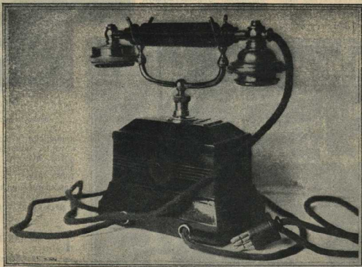
МОСКОВСКИЙ НАСТОЛЬНЫЙ ТЕЛЕФОННЫЙ АППАРАТ: Приборы для слушания (телефон) и разговора (микрофон) скombинированы на общей рукоятке. Кронштейн, на котором она лежит, представляет из себя рычаг, автоматически соединяющийся с телефонной станцией, если трубку снять с кронштейна. В ящике находится звуковое приспособление для вызова.
