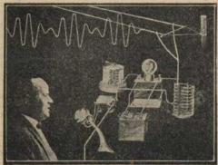
Радиотелеграфные волны, излучаемые под действием тороид, воспринимаемого микрофоном (часть телефонной установки, куда обычно говорят), соответственно изменяются.
