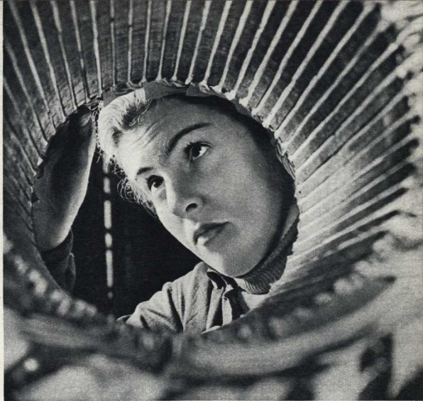
В электроцехе завода «Борец» ученица 11-го класса Тانيا Прокопенчик ведет обмотку электромоторов.
