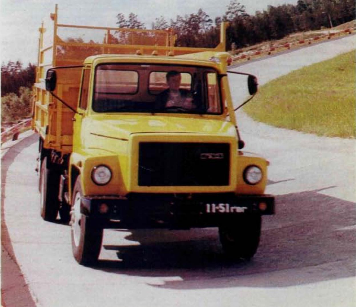
километров в час. Устойчивая минимальная скорость особенно важна при работе с уборочной техникой. Высокая проходимость — гарантия того, что автопоезд не увязнет в распутице на сельских дорогах. Двухконтурная, пневмогидравлическая тормозная система надежно оберегает водителя от неприятностей при езде в горах, на отлогих участках дороги.
