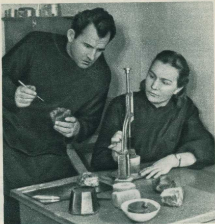
Геологи извлекают образцы грунтов, лежащих на глубине десятков метров, и подвергают их всестороннему исследованию. На снимке: инженер-геолог Виктор Волков и лаборантка Нина Назнова составляют описание образцов грунтов.
