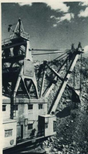
Механическая лопата с новым ёмкостью в 15 кубометров работает на Северном разрезе.
