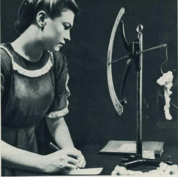
Чтобы проверить, Валентина отмотала от початка немного прядки и осторожно повесила моток на крючок контрольного прибора.
