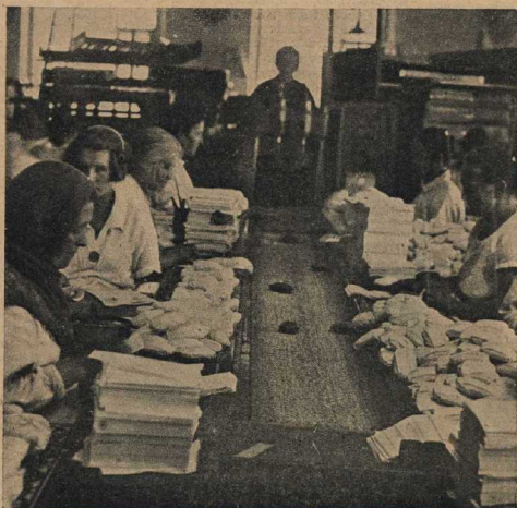
Отделочный цех. Конвейерная система. Куски мыла движутся от формовочного аппарата по бесконечному полотну. Работница производит только одну операцию, завертывая мыло в одну обертку
