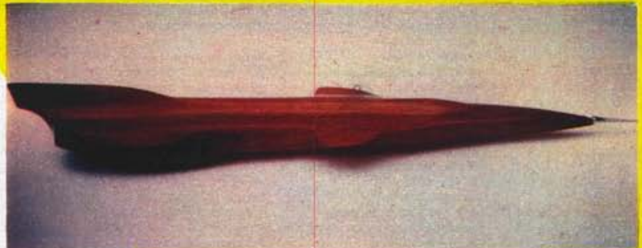
МОДЕЛЬ РЕКОРДНО-ГОНОЧНОГО АВТОМОБИЛЯ, ПРЕДНАЗНАЧЕННАЯ ДЛЯ АЭРОДИНАМИЧЕСКИХ ИСПЫТАНИЙ.
