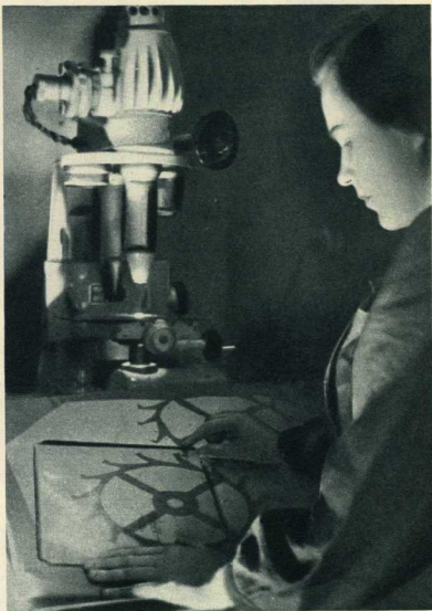
Контролер Валентина Ключникова измеряет точность размера анверсного колеса.
