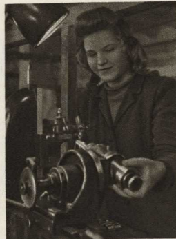
Одна из лучших станочниц участка, комсомолка Нина Никифорова, заносит деления шкалы микроскопа.
