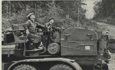
Две автолебедки приводят в действие систему управления аэростатом.
